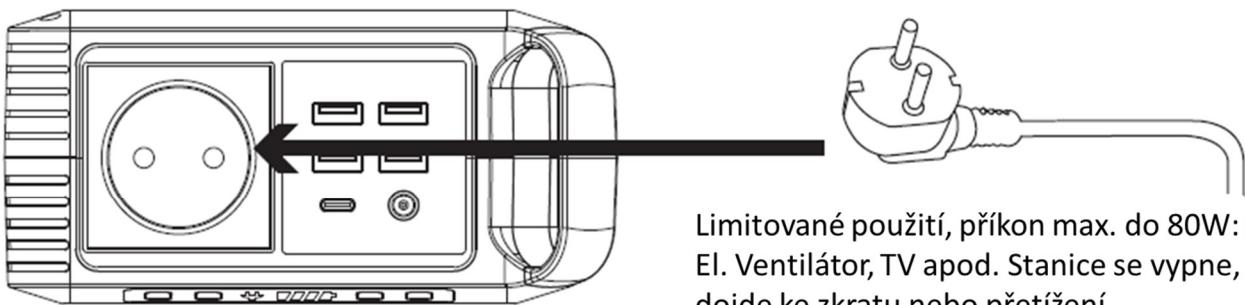
Limitované použití, příkon max. do 80W: světlo, El. Ventilátor, TV apod. Stanice se vypne, pokud dojde ke zkratu nebo přetížení.
